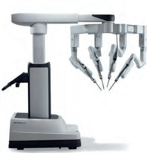
Sistema da Vinci con robot operatore, colonna e consola chirurgica.
